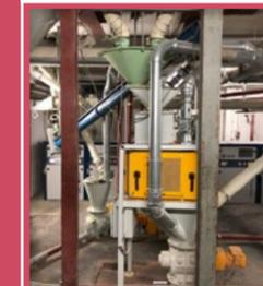
In der Darre wird der ungeschälte Hafer über 1,5 Std. erwärmt. Die Schale des Hafers schützt die empfindlichen Kerne und positiven Inhaltsstoffe wie beispielsweise Vitamin E. Der Geschmack der Schale geht ins Korn über und verleiht dem Produkt ein kräftiges Aroma. Nach der Darre wird der Hafer geschält und zu Flocken verarbeitet.
